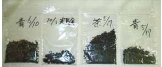
連続投入可能な電磁誘導連続溶融装置により溶融したアスベストを冷却し、自然無害化を急速水冷却処理することにより、2~5mm 程度の粒形に整形できる無公害リサイクルシステムが開発できた。これらの水冷ガラス粒は、耐熱ガラス、装飾ガラス、セメントの骨材等に再利用が可能である。
